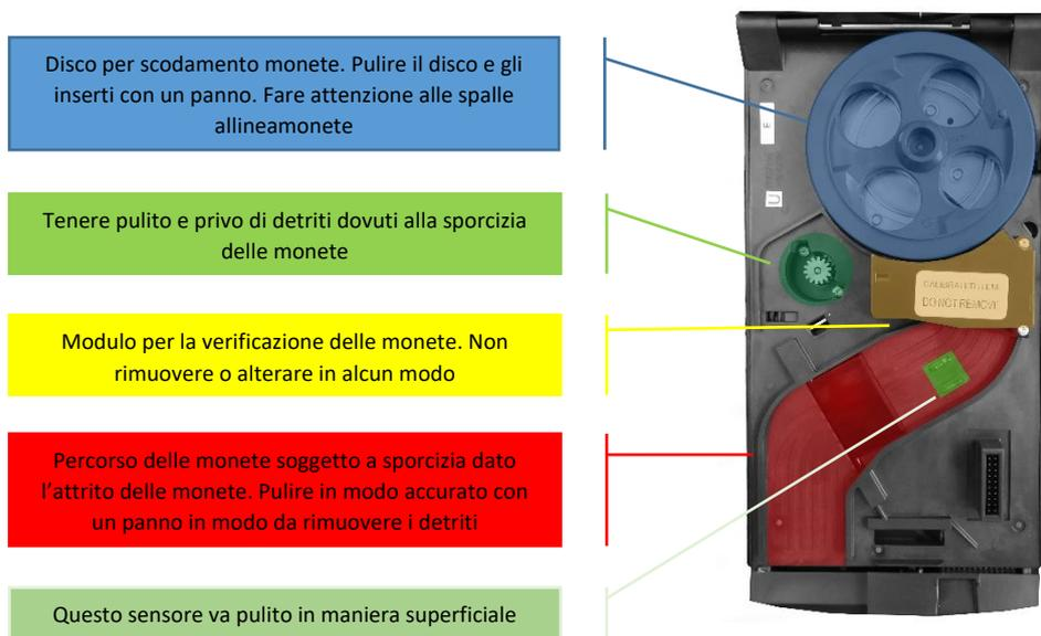
Pulire in maniera accurata il condotto che porta le monete al rotore di cui sopra. E' consigliabile utilizzare una spatola con fibre non aggressive in modo da non danneggiare la macchina.
