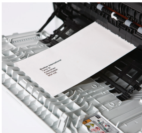
Stampa su buste e supporti più spessi utilizzando il vassoio multiuso
